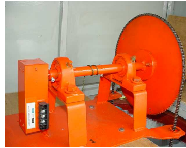
อุปกรณ์วัดระดับน้ำ ใช้หลักการลูกลอย “ชลกร 2” ซึ่งพัฒนาโดย วิษญ์
