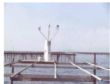
การติดตั้งใช้งานวัดระดับน้ำโดยใช้คลื่นเสียงอุลตราโซนิก
