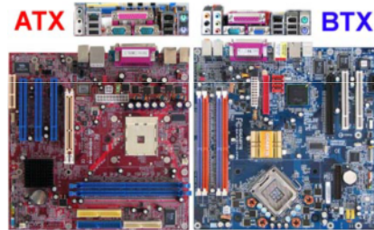
เปรียบเทียบตำแหน่งของวงจรต่างๆ ระหว่าง ATX กับ BTX
