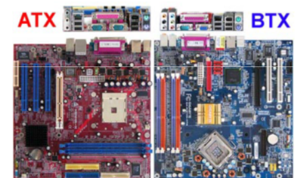
เปรียบเทียบตำแหน่งของการจัดวางระหว่าง ATX กับ BTX
