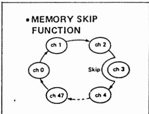
30. สะแกนกระโดดข้ามช่องความถี่ (Memory Skip Function) เนื่องจากเสียง ICOM 2 SAT นี้สามารถเก็บช่องความจำไว้ได้ถึง 48 ช่อง (โดยไม่นับความถี่ใน VFO Mode อีกหนึ่งความถี่) ดังนั้นในการสะแกนช่องความถี่ทุกช่องจะเสียเวลามากกว่าจะครบรอบ ผู้ใช้เครื่องจึงอาจโปรแกรมสั่งให้เครื่องกระโดดข้ามช่องความถี่ที่ไม่ต้องการฟัง โดยซ่อนช่องนั้น ๆ เอาไว้ดังนี้
