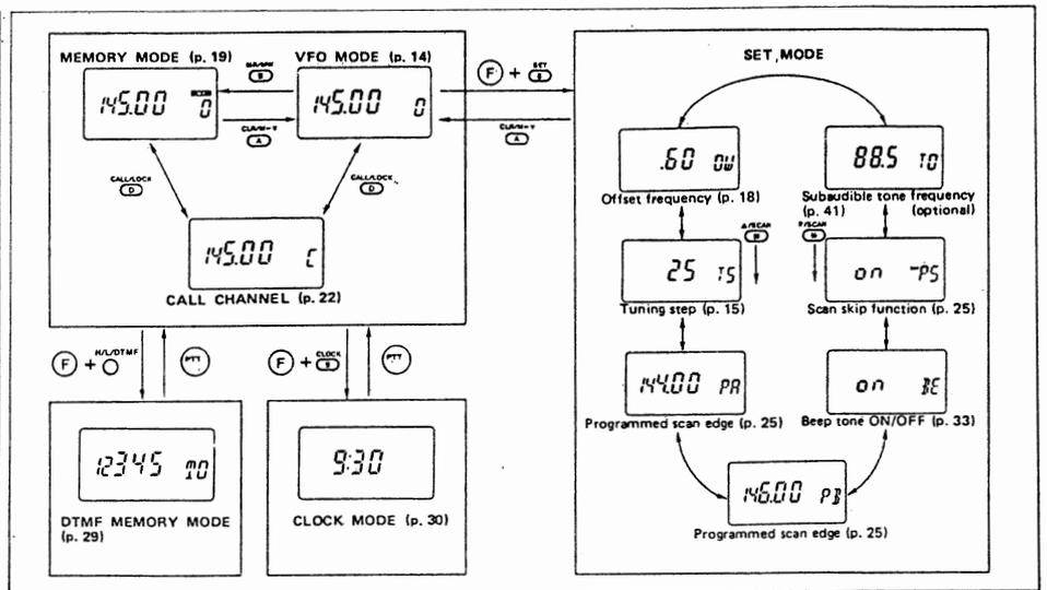
เปลี่ยนความถี่โดยหมุนลูกบิด Tuning Control เพื่อเปลี่ยนความถี่ทีละขั้น แต่ถ้าต้องการเลื่อนเปลี่ยนความถี่ไปเร็ว ๆ กด F ค้างไว้ กด [0] DIAL SET สังเกตขีดเล็ก ๆ ใต้เลขความถี่แต่ละหลัก ชิดอยู่ใต้หลักใด ขณะหมุนลูกบิดจะเปลี่ยนความถี่ของหลักนั้น กด [0] แต่ละครั้ง. (ต้องกด F ค้างอยู่ตลอด) จะเปลี่ยนตำแหน่งของขีดใต้เลขไปเรื่อย ๆ (หลักหน่วยและหลักสิบ KHz ต่อไปถึงหลักหน่วยและหลักสิบ MHz)
