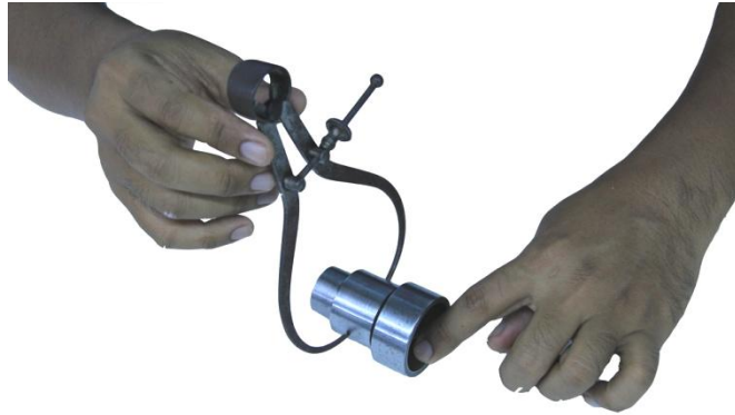
รูปที่ xx การเทียบขนาดชิ้นงานกับวงเวียนวัดนอก
