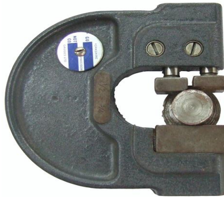
รูปที่ 13 แสดงตัวอย่างการตรวจสอบงานด้วยเกจก้ามปูด้าน NOT GO
