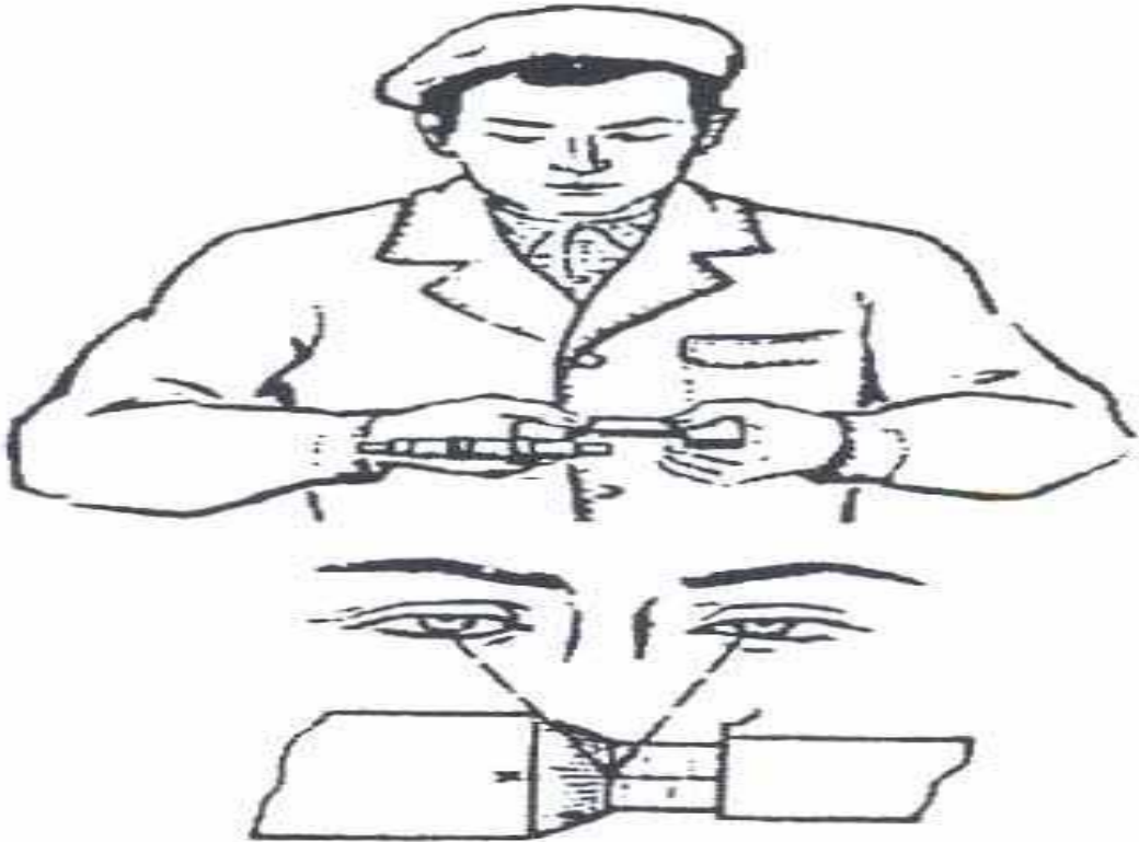
ภาพที่ 5.29 การอ่านตัวเลขบนสเกล
