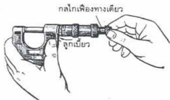
ภาพที่ 5.21 การล็อกแกนวัดด้วยลูกเบี้ยว
