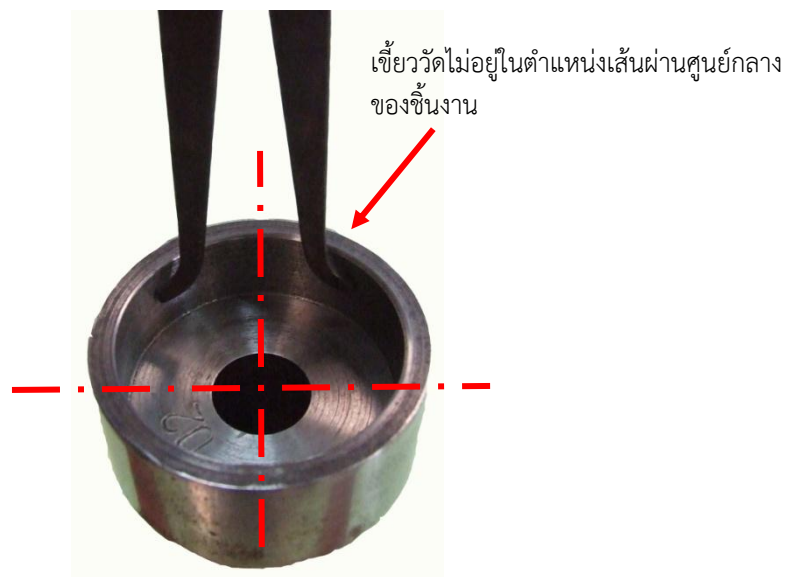
รูปที่ xx ลักษณะการวัดไม่ตรงตำแหน่งเส้นผ่านศูนย์กลาง
