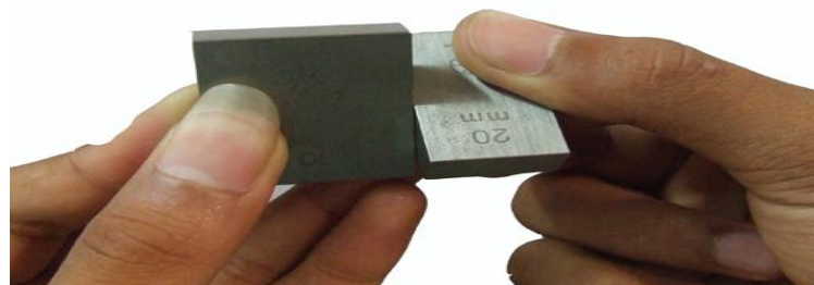
รูปที่ 4 แสดงการถอดเกจบล็อกโดยการหมุนและการเลื่อนออก
