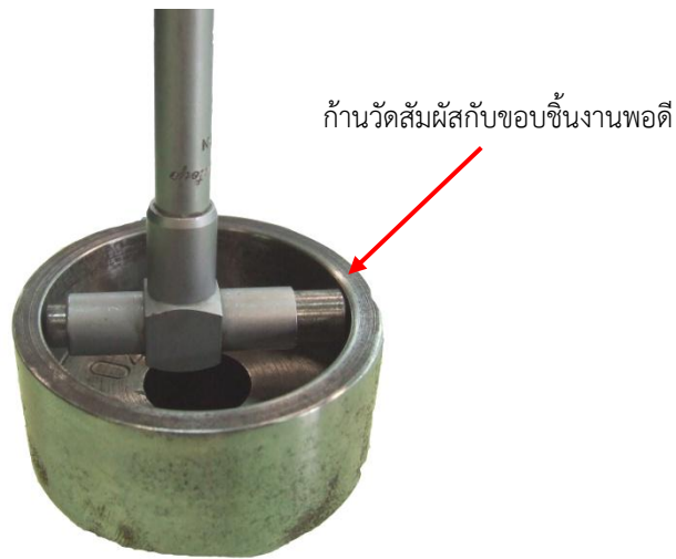
รูปที่ xx ลักษณะการวัดด้วยเทเลสโคปิกเกจ
