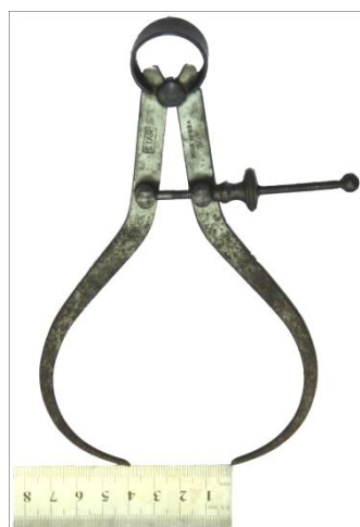
รูปที่ xx การวัดขนาดวงเวียนวัดนอกกับบรรทัดเหล็ก
