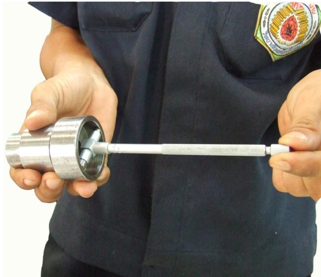
รูปที่ xx ลักษณะการวัดด้วยเทเลสโคปิกเกจ
