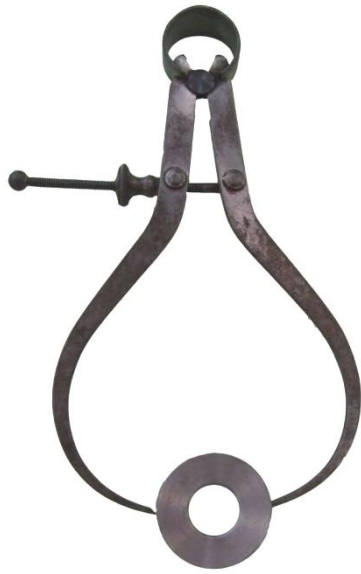
รูปที่ xx การถ่ายขนาดชิ้นงาน
