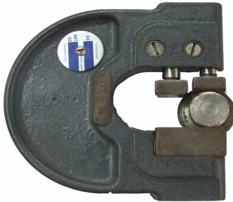
รูปที่ 12 แสดงตัวอย่างการตรวจสอบงานด้วยเกจก้ามปูด้าน GO
