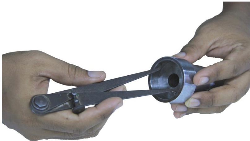
รูปที่ xx การวัดขนาดด้วยวงเวียนวัดใน
