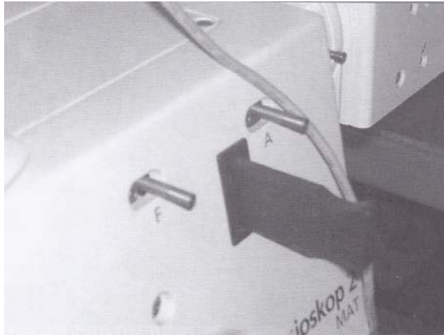
รูปที่ 12 ส่วนประกอบหลักของกล้องจุลทรรศน์แสดง (1) ช่องใส่ฟิลเตอร์ (2) ปุ่มปรับม่านแสง FD และ AD
