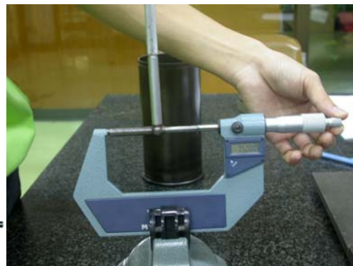
รูปที่ 9 Telescopic gauge และการถ่ายทอดขนาด
