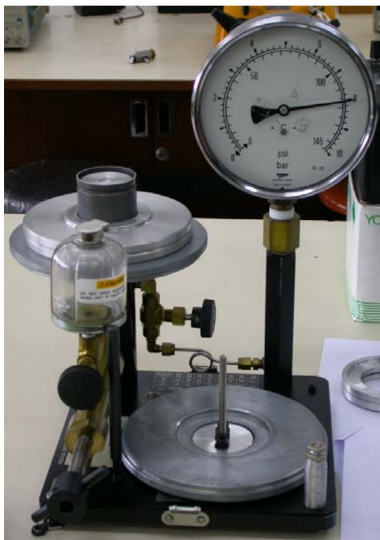
ภาพแสดงการติดตั้งเครื่องมือในการสอบเทียบ (เฉพาะการทดลองนี้)
